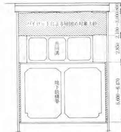
図-5 パイロット使用断面図
