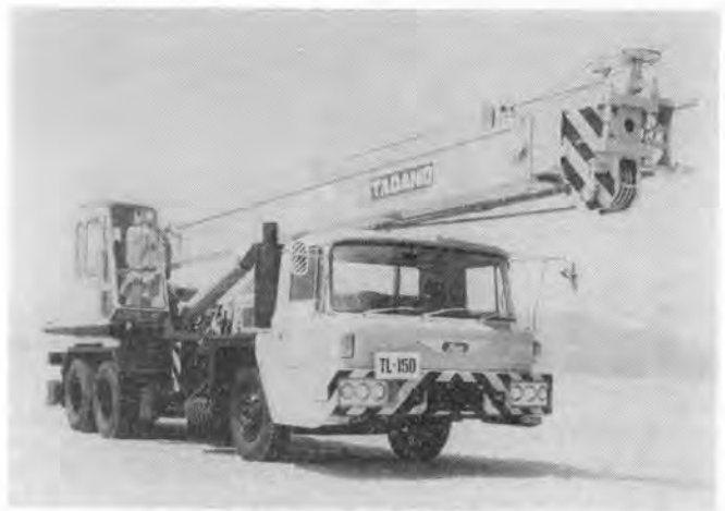
写真 2.2-2 多田野 TL-150 油圧式トラッククレーン
