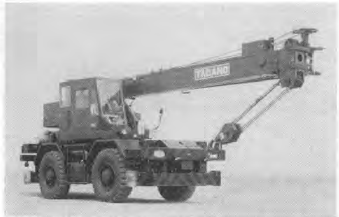
写真 2.2-5 多田野 TR 151 油圧式ホイールクレーン
