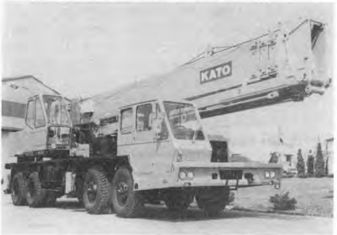
写真 2.2-3 加藤 NK-450 油圧式トラッククレーン
