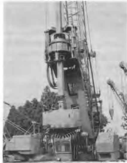
写真3.2-3 日立建機 KH 100 油圧アースドリル
