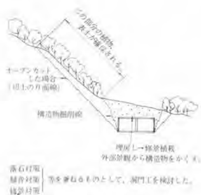
図-2 ボックス形式の洞門工
