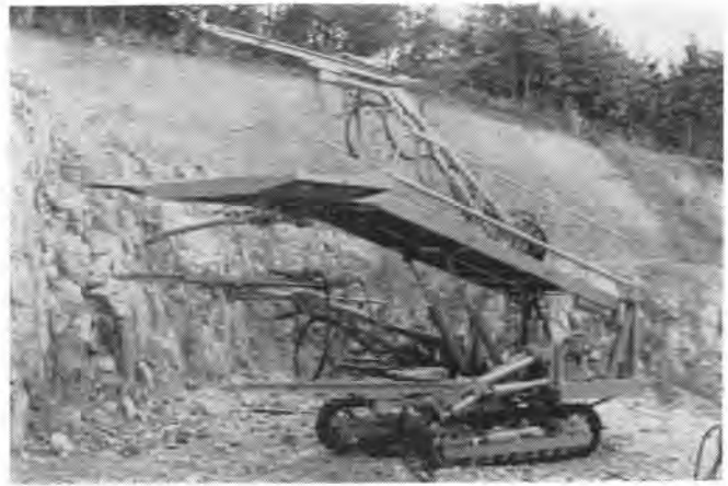
写真 4.1-5 東洋 TYCJ-3 型 3ブームクローラジャンボ
