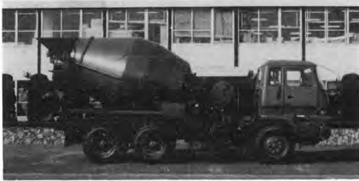
写真 6.2-2 新潟鉄工製 4.4m 3 トラックミキサ車
