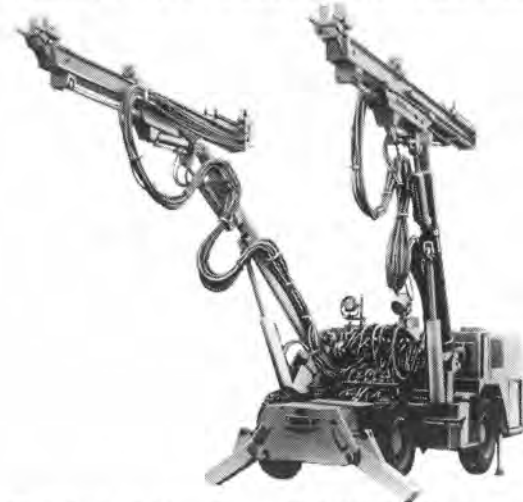
写真 4.1-4 アイムコ・セコマ PEC-1140 型 2ブームモビールジャンボ(三井造船・アイムコ社輸入)
