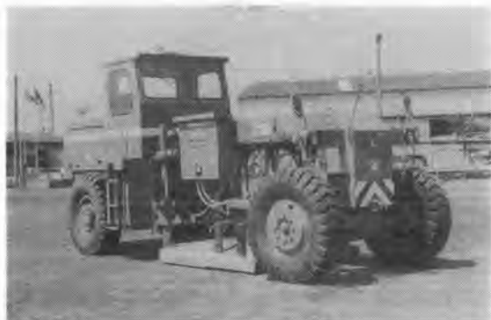
写真-6 路面整正機
