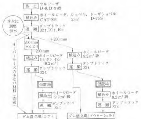
図-5 コア材製造系統および使用重機
