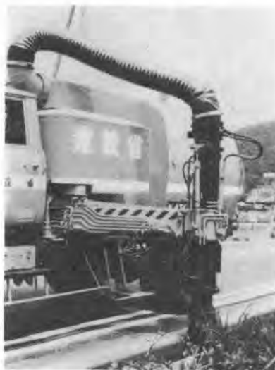
写真8-2 側溝清掃車の掘削装置と支持機構
