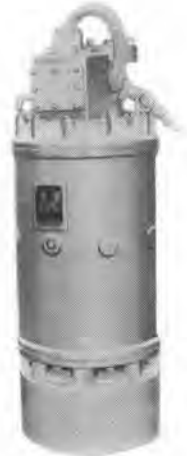
写真11-2 高揚程工事用水中ポンプ 揚程: 120m 吐出量: 1.5 m 3 /min 口径: 150mm 電動機: 75 kW
