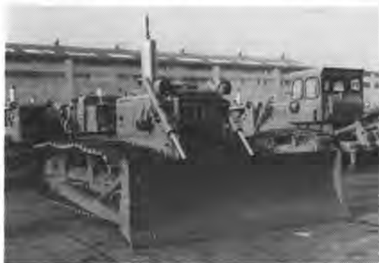
写真-1 低騒音ブルドーザ CAT D5 LGP
