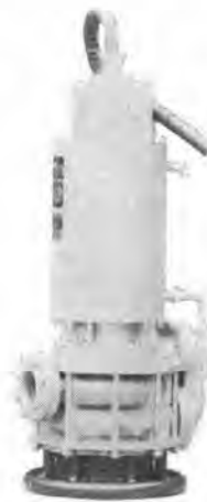
写真11-1 高揚程工事用水中ポンプ 揚程: 80m 吐出量: 1 m 3 /min 口径: 100mm 電動機: 30 kW
