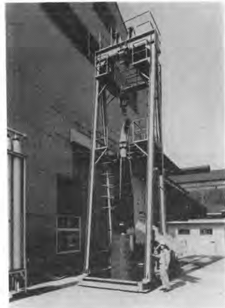
写真-1 重錘式岩盤掘削機 KPC-1200
