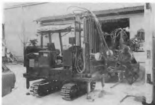
写真-39 垂直コンクリート切断機
