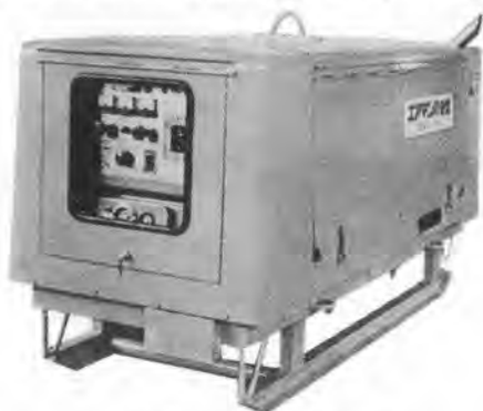
写真12.1-9 防音型発電機
