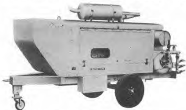
写真12.1-8 防音型コンプレッサ
