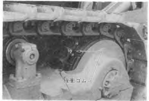
写真-2 スプロケット緩衝ゴム装着状況
