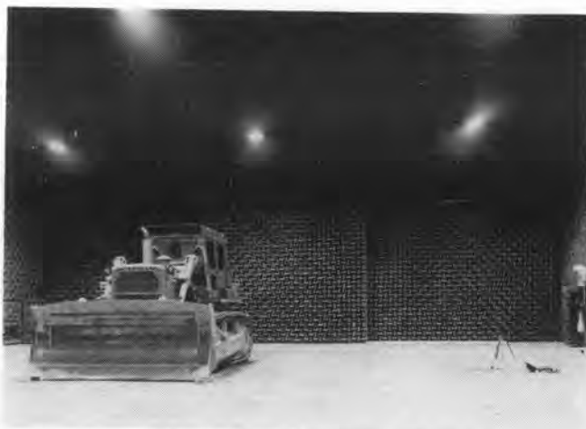
写真-2 キャタピラー社の半無響室
