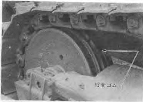
写真-1 アイドラ緩衝ゴム装着状況
