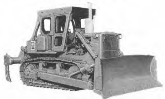
写真-6 オペレータ騒音対策型 ROPS キャブ付 D7G トラックタイプトラクタ
