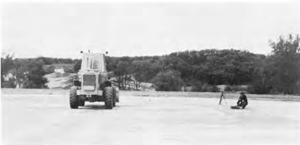
写真-1 SAE J 88a による騒音測定
