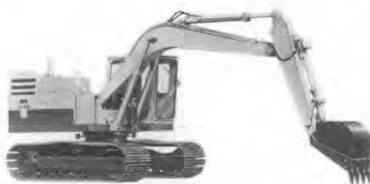
写真-3.3.2 小松 12 HQ パワーショベル
