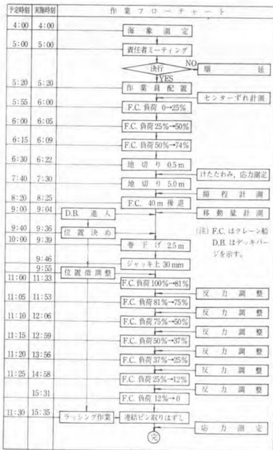
図-8 けた積載時作業フローチャート
