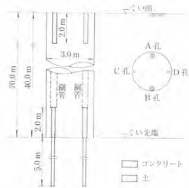
図-7 コアボーリング
