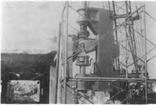
写真-1 TSB 2号機による床版破壊状況
