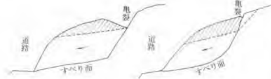
図-7 頂部土塊の一部除去
