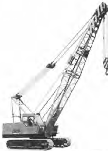
写真-3.5.1 石川島コーリング CH300 全油圧クロウラクレーン
