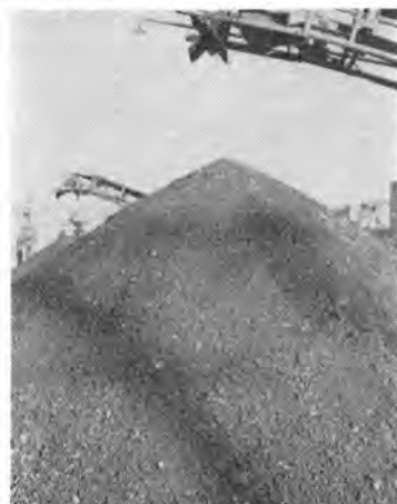
写真-4 アスファルト混合物の破碎物
