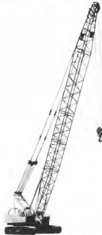
写真-3.5.2 石川島コーリング CH400 全油圧スパンナクレーン
