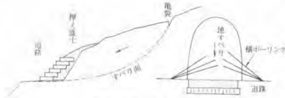
図-6 応急押え盛土工
