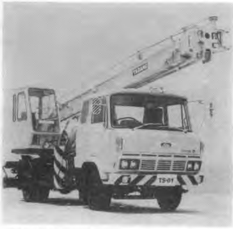
写真-3.5.3 タダノ・ハイドロクレーン TS-61 LN
