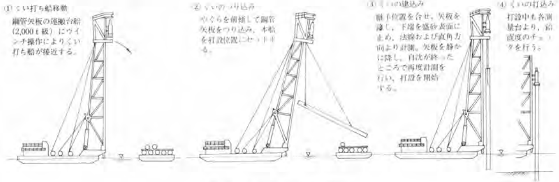
図-8 くい打ち船による打設順序
