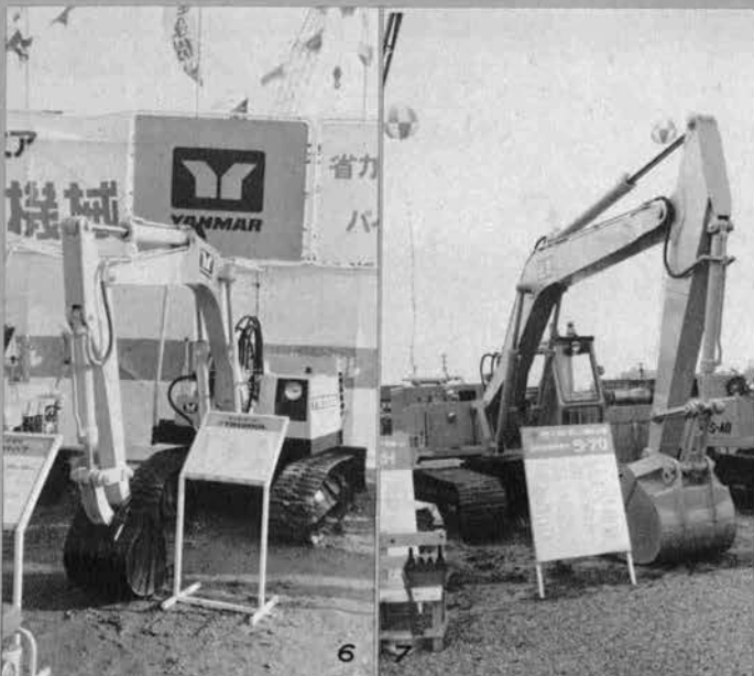
6. ミニバックホウは排土板付のものが多い（ヤンマーディーゼル YTB-1200 L, 0.1 \text{ m}^3 ）—福岡— 7. 無線でリモートコントロールできるバックホウで、ベンチ上にあるのが操作装置（住友重機 S-70, 0.7 \text{ m}^3 ）—新潟— 8. 機動性と安定性の相反する機能をうまくまとめた油圧バックホウ（東洋運搬機・バンゴン 14 C, 0.7 \text{ m}^3 ）—福岡—
