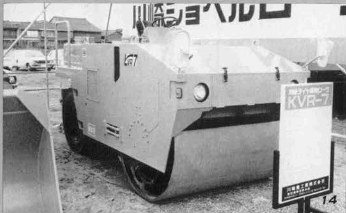
14. 全油圧駆動の大型振動ローラで、操向輪は空気タイヤのコンバインド型 (川崎重工 KVR-7, 7 t) —新潟—
