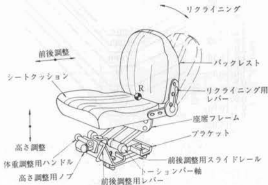
図-1 小松大型ブルドーザに使用のサスペンションシート
