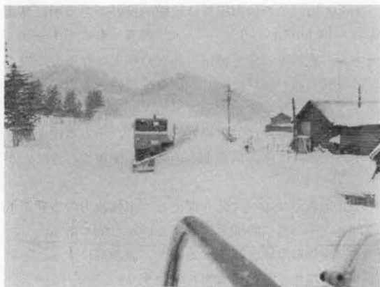
写真-2 高速除雪時 (50 km/hr) の前方視界
