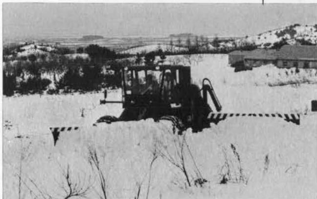
除雪ドーザ 180 B (サイドウイング付) 機関出力 160 PS, 重量 18,100 kg, ホール式の大型強力除雪車で深雪用 —東洋運搬機—
