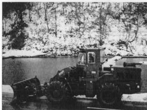
除雪ドーザ KLD 70 (アングリングブラウ付) 機関出力 145 PS, 重量 13,350 kg, やや深い雪や吹溜りの処理に威力のある大型除雪車 —川崎重工—
