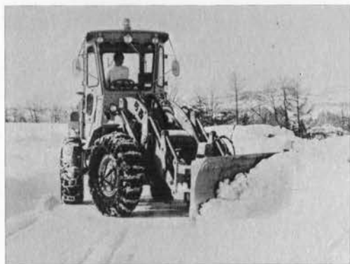
除雪ドーザ CAT 920 (スライド式アングリングブラウ付) 機関出力 82 PS, 重量 9,340 kg, ブラウを左右にスライドさせて路肩などの除雪に使用 —キャタピラー三菱—
