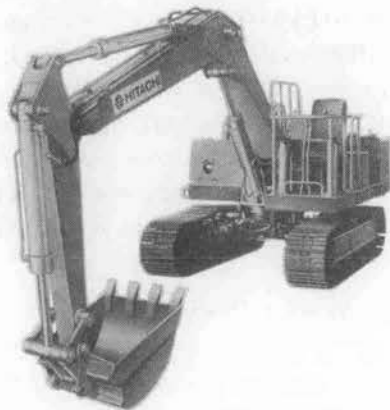
写真-3.2.8 日立 1t 分解型 UH 02 油圧ショベル
