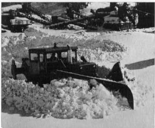
除雪ドーザ D 60 A (V ブラウ付) 機関出力 140 PS, 重量 16,410 kg, 山間部吹溜り等の除雪用 —小松製作—
