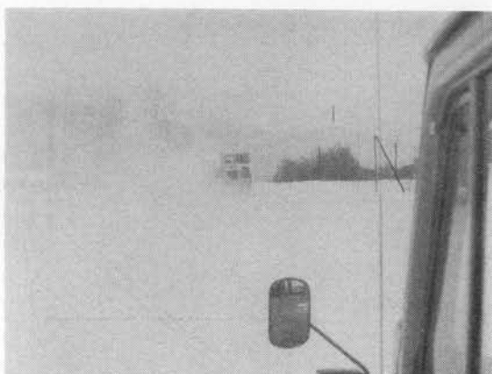
写真-3 低速除雪時 (20 km/hr) の後方視界
