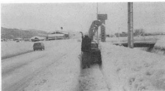
写真-4 ハンドガイド型車輪式による歩道除雪
