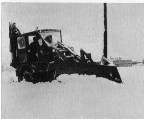
除雪ドーザ HL 8 (V ブラウ付) 機関出力 44.5 PS, 重量 6,510 kg, 狭い山間道路などに用いられる小型の除雪ドーザ —三井造船—
