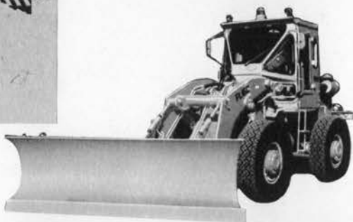
除雪ドーザ FL 160 (スライド式アングリングブラウ付) 機関出力 100 PS, 重量 10,880 kg, いろいろな除雪条件に適応できる中型除雪ドーザ —古河鉱業—
