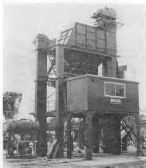
写真-3.12.1 新潟 NP 1000 A アスファルトプラント
