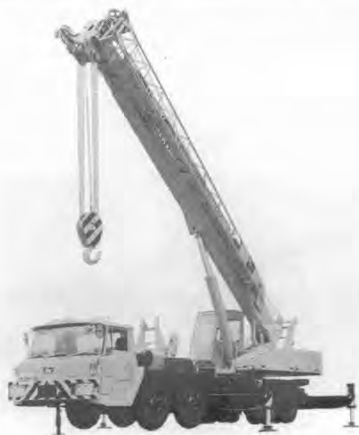
写真-3.5.1 多田野 TL-251 ハイドロクレーン
