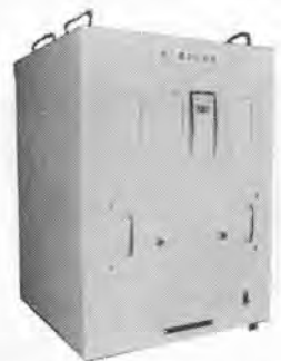
写真-3.17.1 日立造船スラリー用差圧式濃度測定装置
