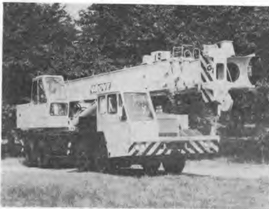
写真-3.5.3 GROVE TMS 3500 トラッククレーン
