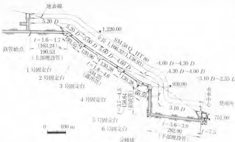
図-2 水圧管路縦断面
