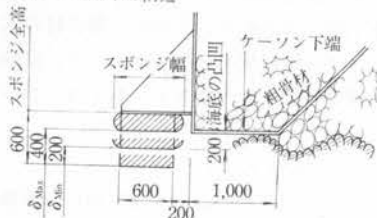
図4 モルタル漏えい防止用スポンジシールの力学特性とスポンジマットの構造
