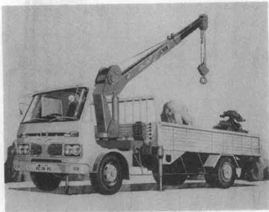
写真-4 南星 PC-2015 パワークレーン
