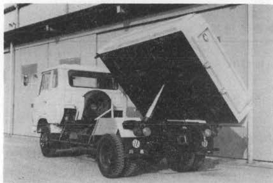
写真-9 川西 DT 4 三転ダンプトラック
