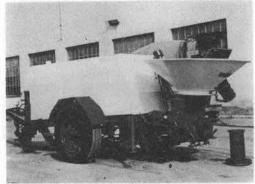
写真-6 コンクリートポンプ車（イコマ社製）
