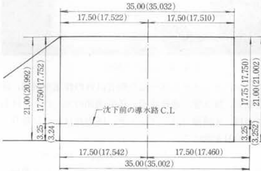
図-10 ケーソン沈下完了後の水平方向のずれ
