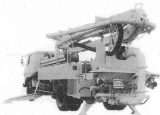
写真-12 三菱シェビング S 115 B コンクリートポンプ車
