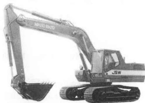
写真-3 日鋼 BH 70 油圧ショベル
