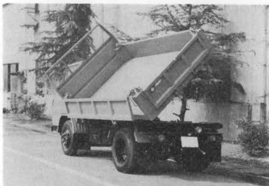
写真-8 川西 DT 2 三転ダンプトラック
