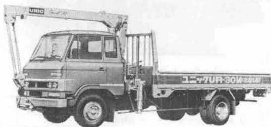
写真-8 ユニック UR-30 M トラック搭載型クレーン
