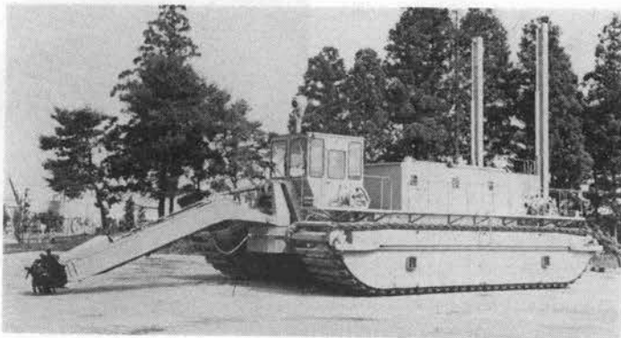
写真-2 水路浚渫機
