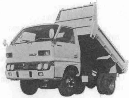
写真-5 いすゞ TLD 64 DMC ダンディダンプなどしている。荷台長さからディーゼルに標準とロングの 2 種、ガソリンに標準の 1 種がある。
