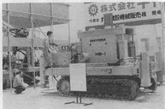
自重を利用して油圧により鋼矢板を圧入するくい圧入引抜機
