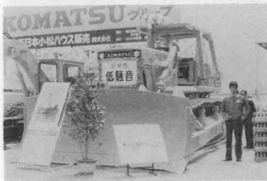
エンジンルーム、消音器に騒音対策を施した ROPS 付ブルドーザ
