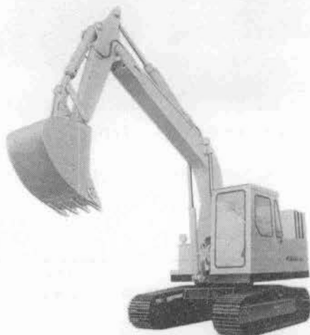
写真-3 神鋼低騒音型 R 904 A-SS 油圧ショベル
