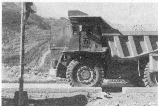
写真-2 運搬車両自動運行管理装置 (受光器とダンプトラック)
