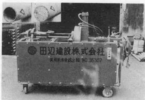
写真-42 単管内コンクリート除去機
