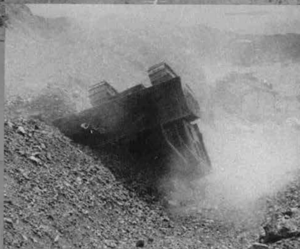
▲転倒実験場（実験車は転倒2回 転目に入った状態）
