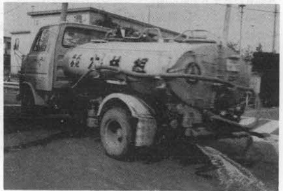
写真-4 散水車による散水（約1時間に1回散水）
