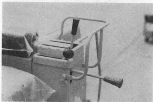
写真-1 履帯式パワーシフトの安全レバー
