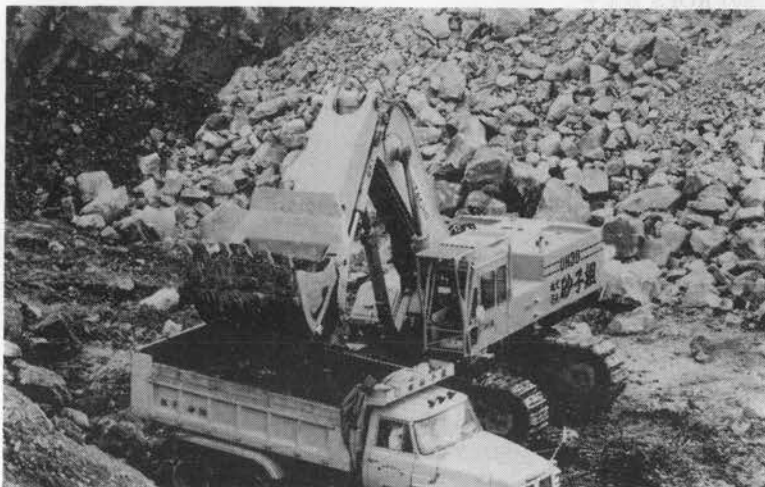
写真-1 UH 30 油圧ショベル (支柱式ヘッドガードおよびビルガード付ローダバケット装着)
