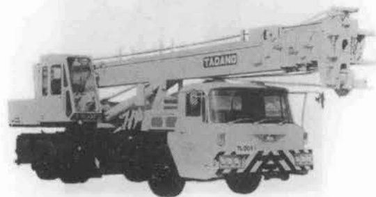
写真-4 多田野 TL 201 ハイドロクレーン
