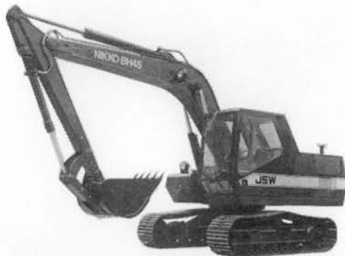
写真-1 日鋼 BH 45 油圧ショベル
