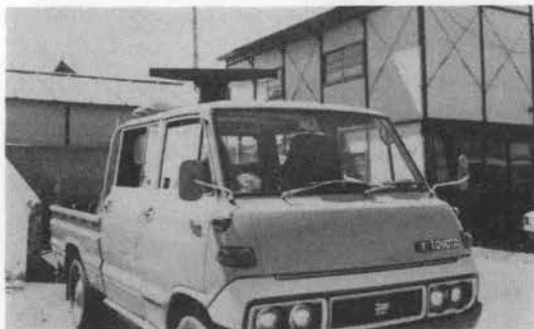
写真-12 除雪車用レーダ空中線部
