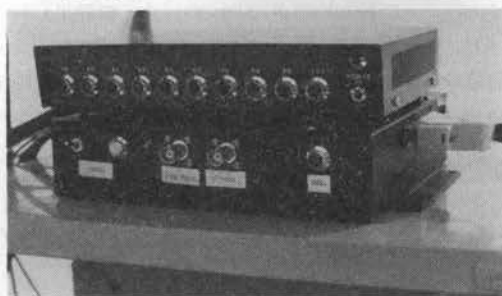
写真-5 車両衝突防止レーダ表示部 (ランプ表示方式) ↓
