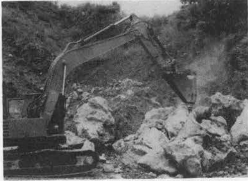
写真-9 クルップ MKB 1000 油圧ブレーカ
