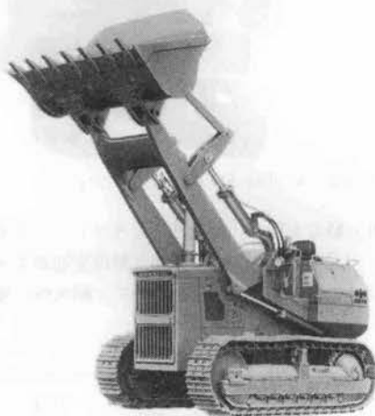
写真-5 小松 D 57 S ドーザショベル
