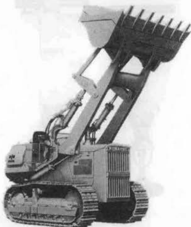
写真-4 小松 D 50 S-16 ドーザショベル
