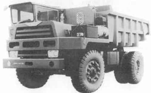
写真-6 日野 ZG 150 改トンネルダンプ
