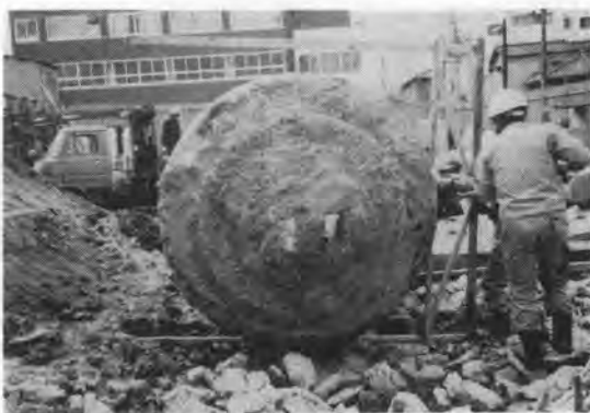
写真-4 TKR ぐいの底面(形状寸法測定およびスライム観察)
