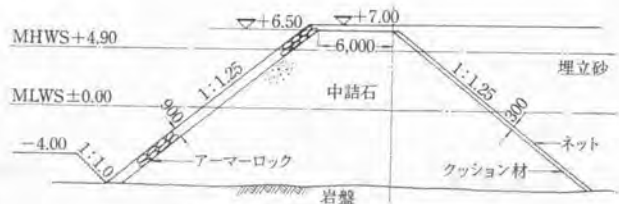
図-3 埋立護岸標準断面図
