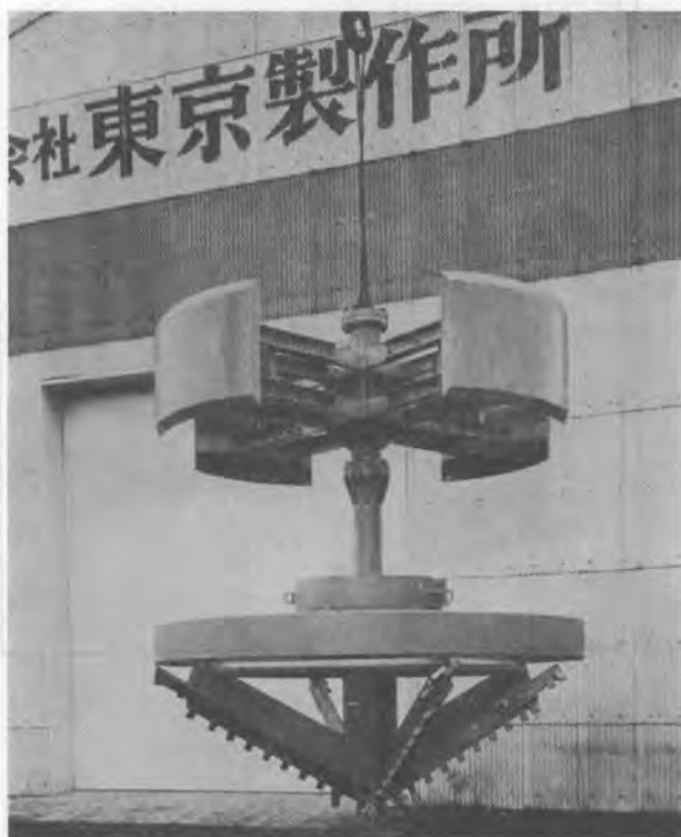
東電九段変電所工事、3000φ～3500φ四翼ビット、ウエイト取付型、スタビライザー付き、52年8月納入。
