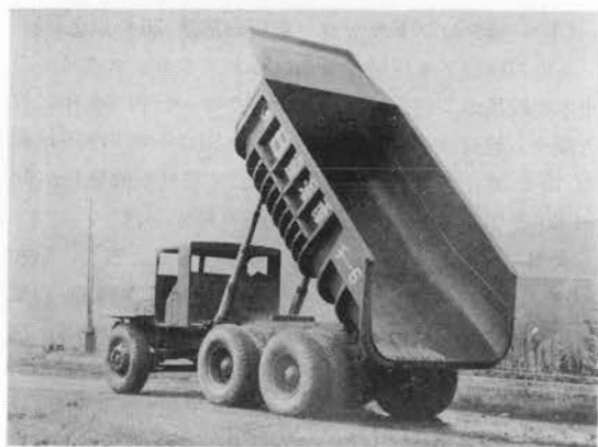
写真2 いすゞ TH 10 型 (ダンプ角度 52°) 現在の工法でもむずかしい形状が良くきれいにでき上がっている。当時の苦勞がしのばれる。
