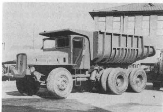
写真1 いすゞ TH 10 型 20t 積ダンプトラック 昭和18年チーゼル自動車(現いすゞ自動車)製。製作後すぐ海外へ持ち出されたのでほとんど人目にかかる機会はなかつた。
