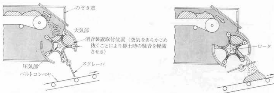
図-4 ロータリフィーダ作動原理図
