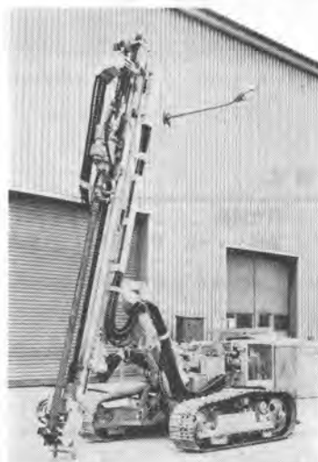
写真-6 三菱 MCD 7 電動型全油圧式クローラドリル
