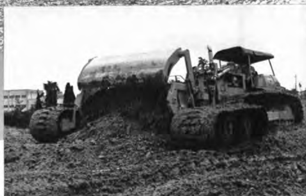
超軟弱地盤用推進型スクレーパ▶ “クローバ” —国土開発工業—
