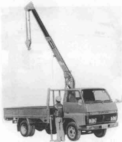
写真-7 ユニック UR-20S クレーン
