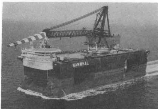
写真-9 石川島播磨自航式半潜水式海上作業船 「ナール」
