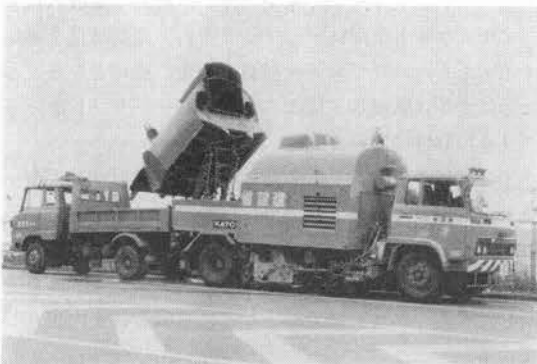
写真-2 リフトダンプ式路面清掃車（塵埃積替え作業中）
