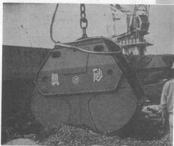
電動油圧式グラブバケット
