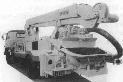
写真-12 極東開発 スクイーズクリート PH 14-70 コンクリートポンプ車
