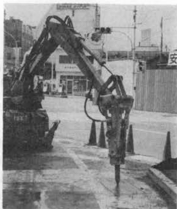
写真-10 渡辺モンタペール BRH 125 油圧ブレイカ 性を高めることができ、騒音も低く、保守点検も容易である。
