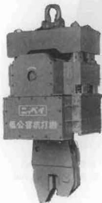
← 写真-7 ニッペイ NLP 60-2 低公害くい打ち機
