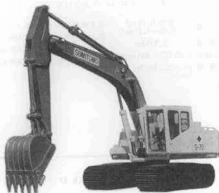
写真-2 住友 S-70 油圧ショベル
