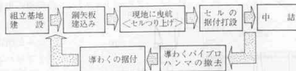
図-1 クレーン船方式による施工手順
