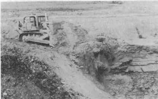
写真-1 米国のコールドマイニングで表土の除去作業に従事する世界最大級のブルドーザ
