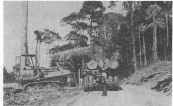
写真-5 インドネシアのロギング現場で木材積込作業に従事するクロアラローダ
