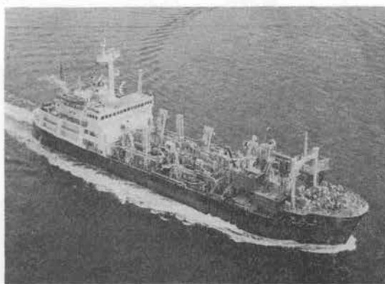
写真-8 三菱油回収兼用ポンプ浚渫船
