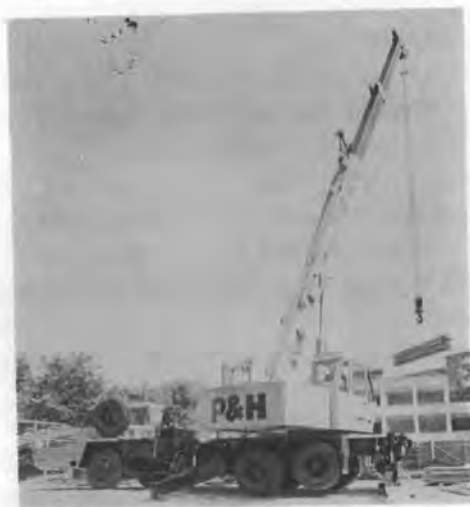
写真-3 神鋼 T-160 油圧式トラッククレーン
