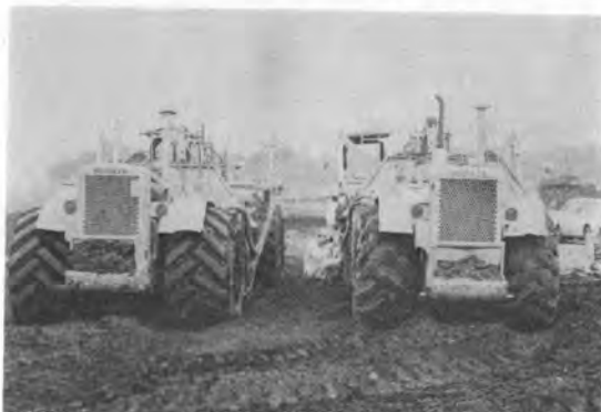
写真-5 テスト機に装着された(左)超ワイドタイヤ H/B=0.66 , (右)ワイドタイヤ H/B=0.82
