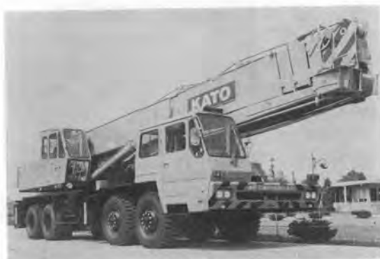
写真-4 加藤 NK-450 B 油圧式トラッククレーン
