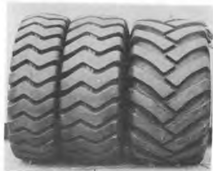
写真-9 右は 15 SBW に採用されている超ワイドタイヤ H/B=0.6 、中央はワイドタイヤ H/B=0.8 、左はスタンダードタイヤ H/B=1.0
