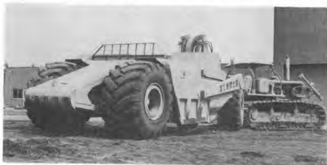
写真-1 超ワイドタイヤを装着した湿地スクレーパ・コクド 15SBW (トラクタは CAT D7G LGP)
