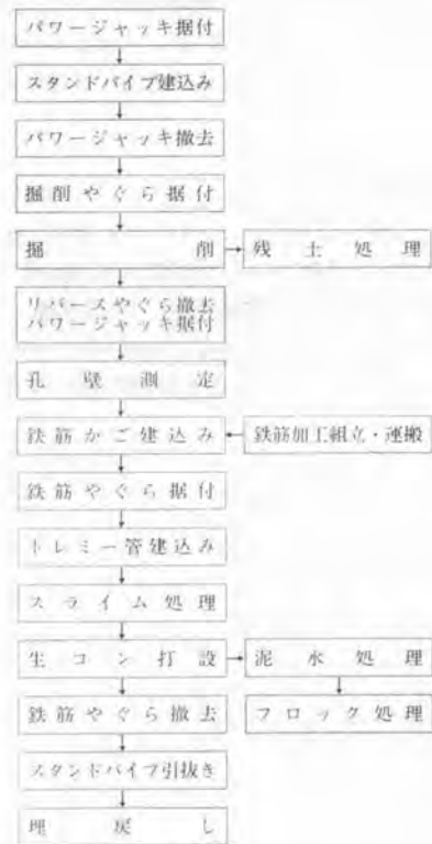
図-3 施工フローチャート
