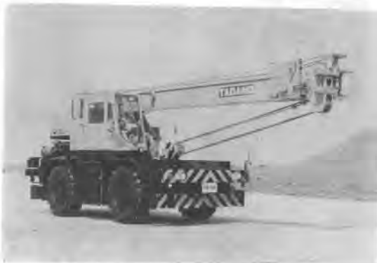
写真-6 多田野 TR-151 油圧式ホイールクレーン
