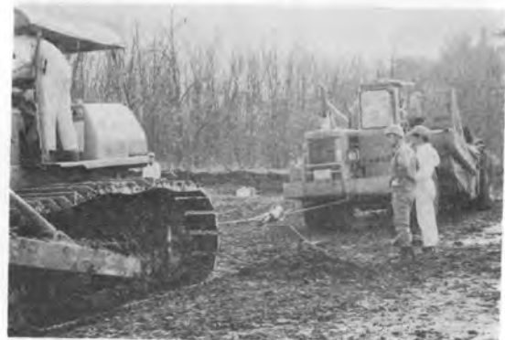
写真-6 ブルドーザでけん引して回転抵抗の測定
