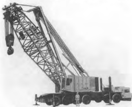
写真-5 住友 HC-258 J 機械式トラッククレーン
