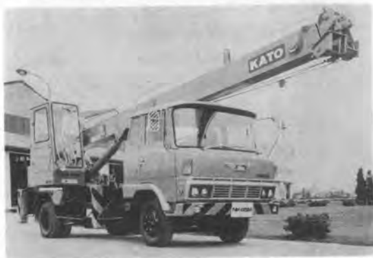
写真-2 加藤 NK-65 M 油圧式トラッククレーン
