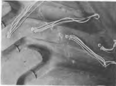
写真-7 タイヤの接地圧測定のためタイヤトレッドに取付けられた特殊ロードセル
