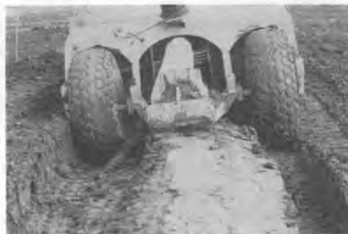
写真-11 コクド 8SA スクレーパ(タイヤ H/B=1.0), 走行抵抗が大きく、わだち跡も深く、難行後沈車
