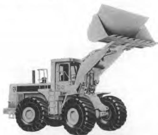
写真-1 CAT 980 C ホイールローダ (ROPS キャブは特別装備品)
