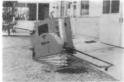
写真-8 三笠 MCD-6 コンクリートカッタ
