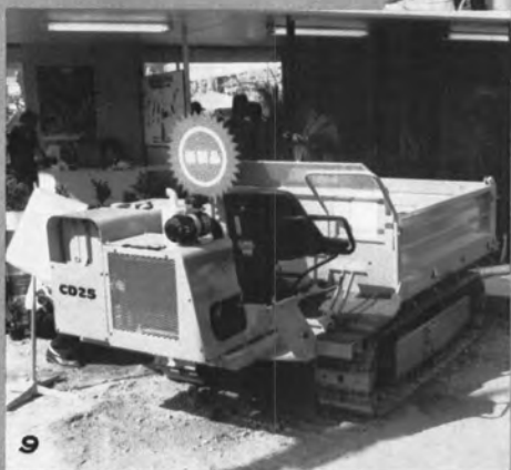
9. 不整地用小型運搬車もふえている。小松 CD 25 (1.2 m 3 , 14.5 PS)
