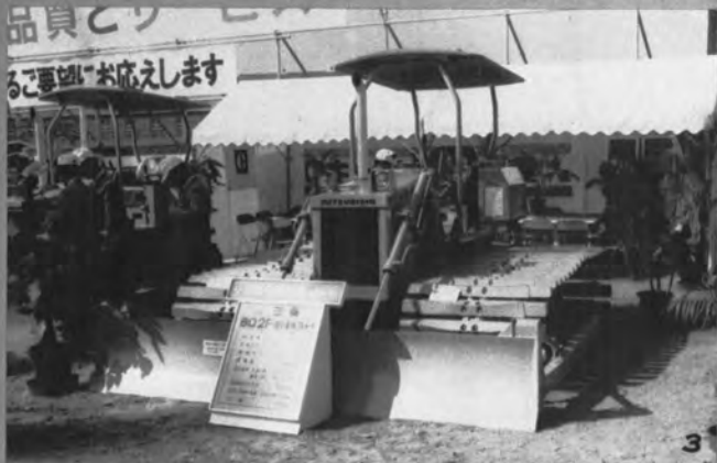
3. 超々湿地の小型ブルドーザ・三菱 BD 2 F (4.2t, 接地圧 0.11 kg/cm 2 )
