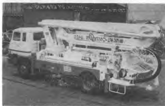
写真-1 ブーム付コンクリートポンプ車 (IHI PTF 75 BZ)
