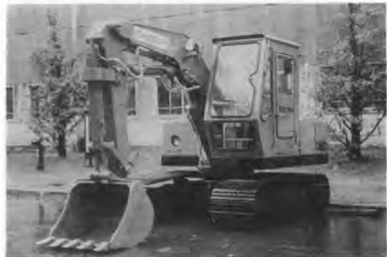
写真-2 日立 UH 02 ショートリーチショベル
