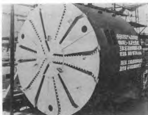
写真-5 国産最大径土圧式シールド
