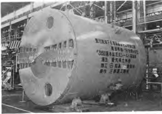
写真-2 振動ふるい付泥水加圧式シールド掘削機
