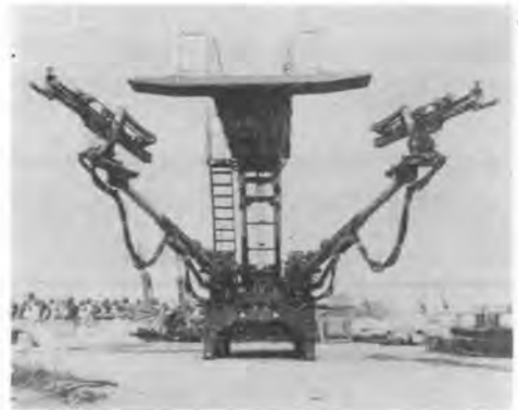
写真一2 2ブーム全油圧式クローラドリル
