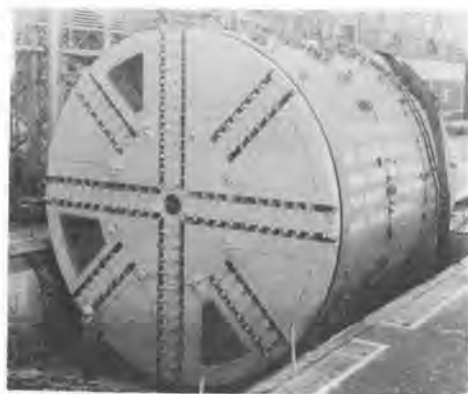
写真-1 \phi 7,290 現有国産最大泥水加圧式シールド掘削機
