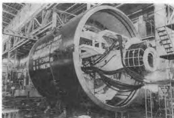
写真-4 連続れき排出装置付トンネル内蔵型泥水加圧式シールド掘削機
