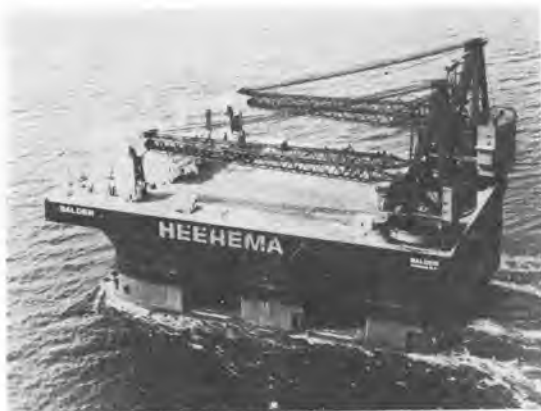
写真-11 自航式半没水型クレーン船ボルダー号
