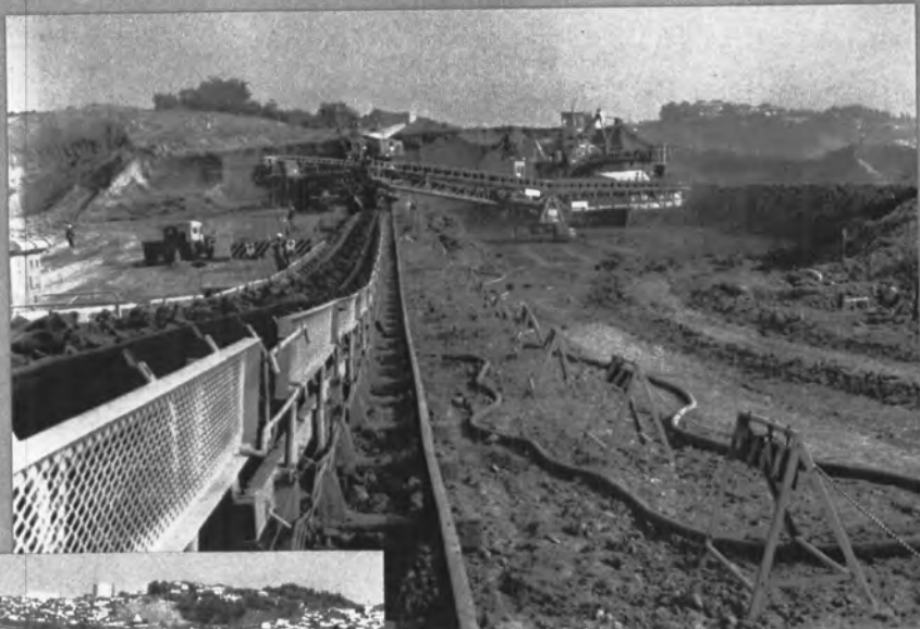
◆場内コンベヤ、右側に見えるのは シフト用レール
