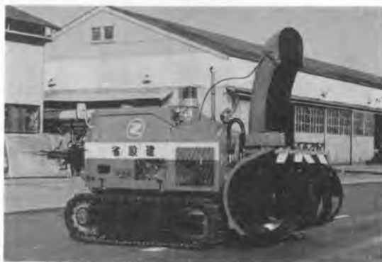
写真-11 ハンドガイド式小型除雪車 (建設省東北技術 SC-3D型)
