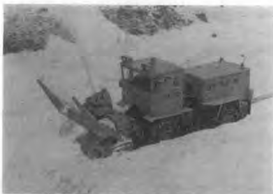
写真一7 400 PS 級ロータリ除雪車 (日本除雪機 HTR-303 A 型)
