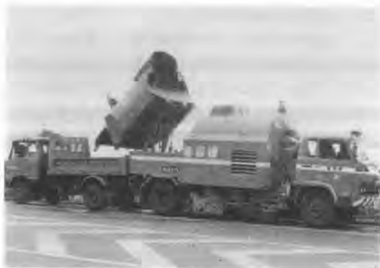
写真-1 リフトダンプ型真空吸込式路面清掃車 (加藤 HS-60 型)
