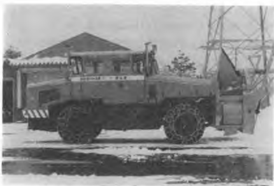
写真一8 500 PS 級ロータリ除雪車 (西ドイツ・パイルハック社 HS-293 型)
