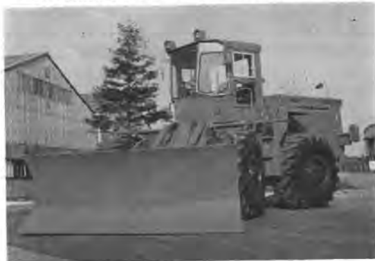
写真-9 18t級除雪ドーザ（東洋運搬機 180S型）
