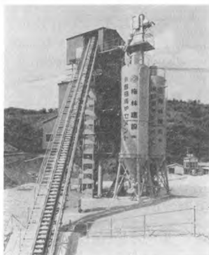
← 写真-5 石灰石の焼成炉装入用に使用されたフレクスベル（85° の急傾斜、約 70 m の高揚程で使用、新日鉄君津製鉄所）
