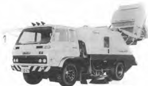
写真-2 リフトダンプ型ブラシ式路面清掃車 (豊和 HF 95 H 型)
