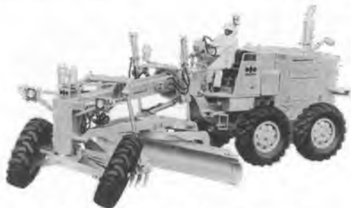
写真-9 小松 GD 605 A モータグレータ
