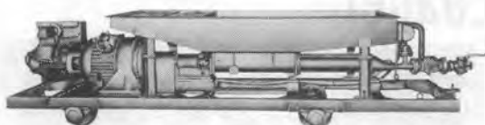
↑セグメント裏込めモルタル専用ポンプKH型
