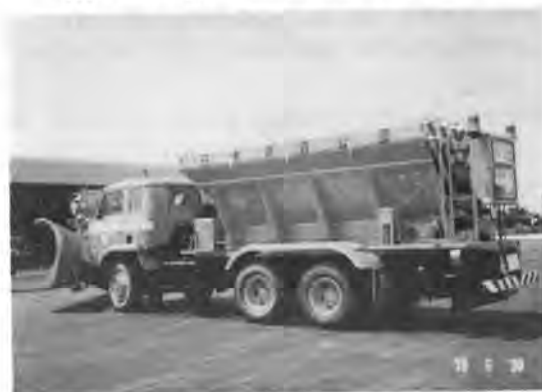
写真-10 凍結防止剤散布装置（10m 3 ）付除雪トラック（範多機械 MS-100 BIT(F)型）
