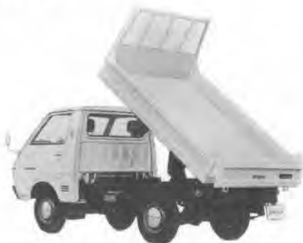
写真-7 トヨタ H-KM 11 D-JDJ ライトエースダンプトラック
