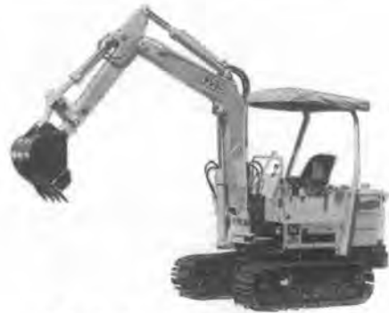
写真-2 ヤンマー YB 1200 SL バックホウ
