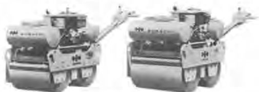
写真-10 小松 JV 06 H, JV 08 H 振動ローラ
