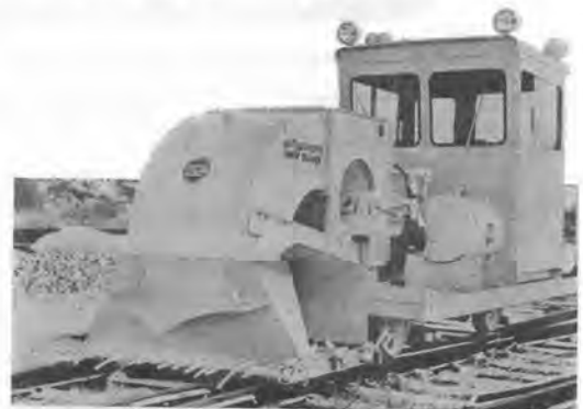
写真-4 自走式ポイント除雪機
