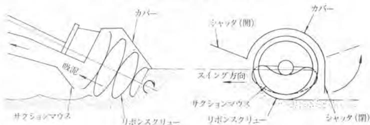
図-6 リボンスクリューの原理
