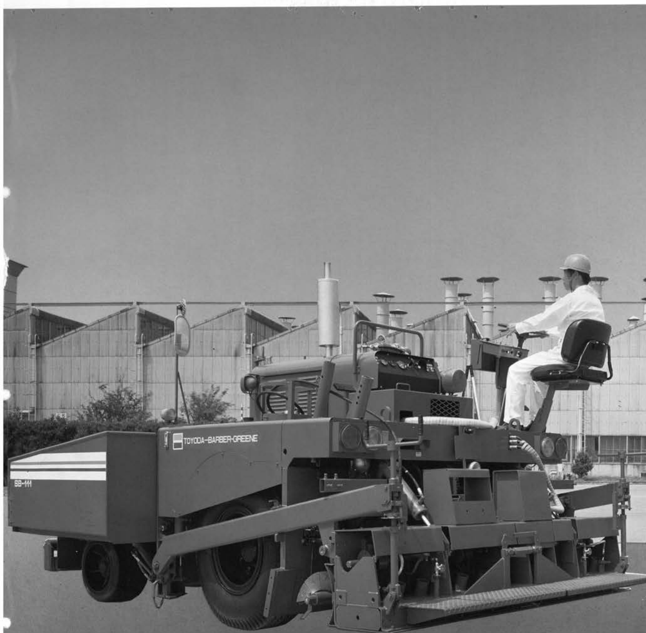
SB111型アスファルトフィニッシャ
