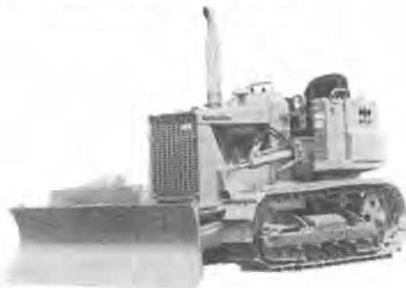
写真-1 小松 D21A-5 パワーアングルチルトドーザ
