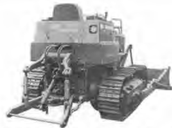
写真-2 小松 D 30 AF-16 農業用クローラトラクタ (油圧駆動)
