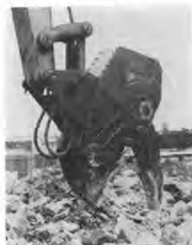
写真-11 新菱 NP-2 コンクリート破碎機
