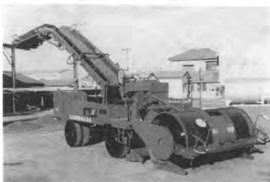
写真-14 東京工機 MT-RC 202 ロードクリーナ
