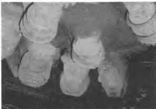
写真-1 偏摩耗したカッタ
