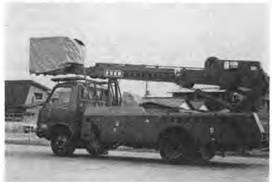
写真-3 高所作業車
