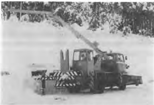
写真-5 雪底処理車
