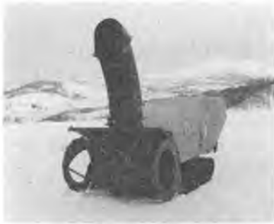
写真-6 小型ロータリ除雪機
