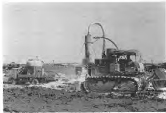
写真-7 軟弱濁土処理実験機
