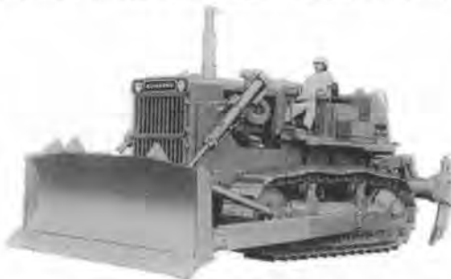
写真-1 小松 D 85 A-18 ブルドーザ
