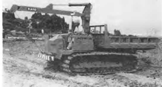
写真-3 クローラ式クレーン付運搬車
