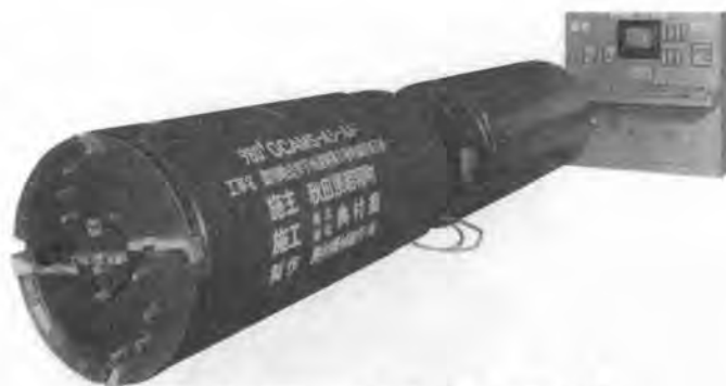
写真-27 φ800mm 泥水式セミシールド掘進機
