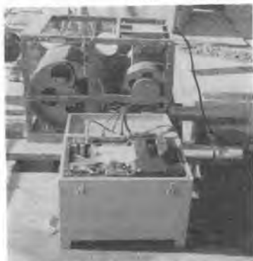
写真-15 超音波孔壁測定機 DM-686 II
