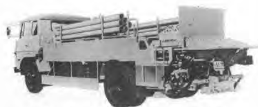
写真-10 三菱 S 120 コンクリートポンプ車
