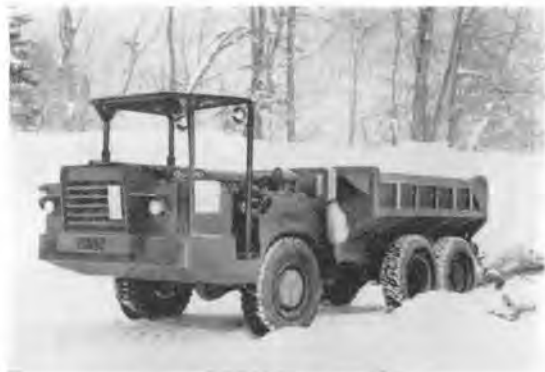
写真-2 坑内用ダンプトラック
