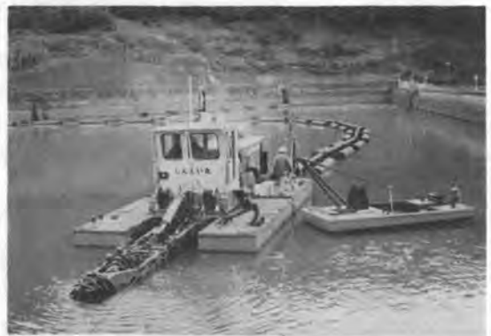
写真-42 可搬式ポンプ浚渫船
