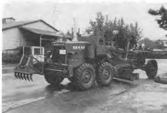
写真-31 ブレードウイング・サイドシフトスカリファイヤ付モータグレーダ
