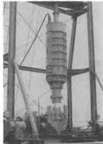
写真一9 TT 0610 型拡底水中掘削機
