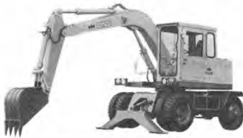
写真-4 小松 10-H 4 W-2 ホイール式油圧ショベル
