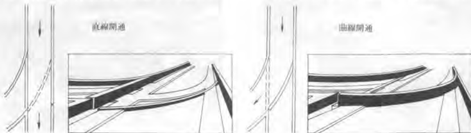
図-6 浮沈式分岐器模式図
