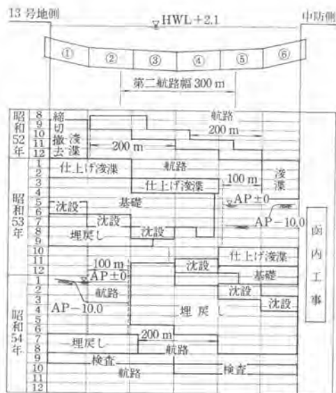
図-3 沈設工程および軌路切替図
