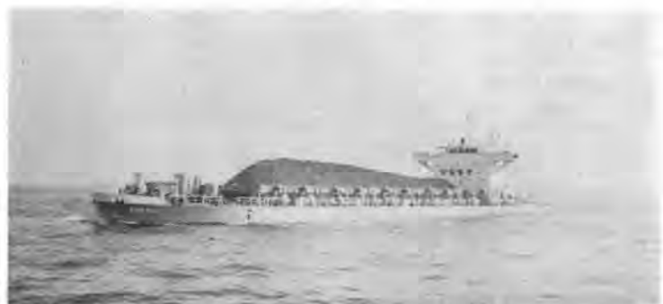
写真-1 大型土運船による置換砂運搬
