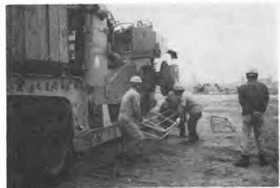
写真-3 サイドバンパの取付(取付け後、スプロケットホイール等を取りはずす)
