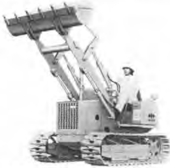
写真-7 小松 D10Q-2 湿地ドーザショベル
