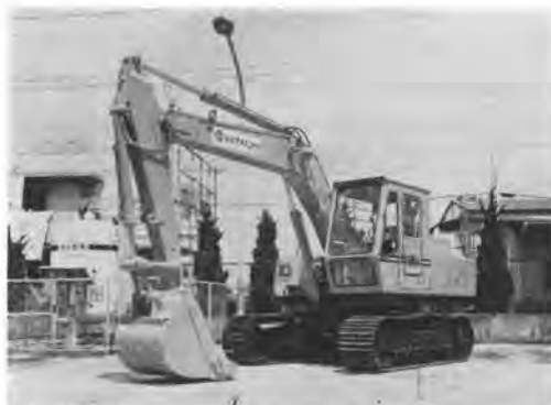
写真-2 日立 UH04-3 1.2t 分解型ショベル
