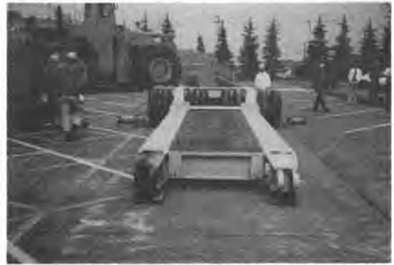
写真-2 グースネック、サイドバンパを取りはずし、ブルドーザがフレームを跨いで進入できる状態の荷台フレーム部
