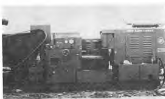
写真-1 コンクリートポンプ
