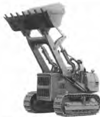
写真-8 小松 D45S-1 ドーザショベル
