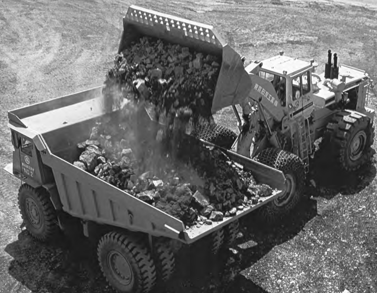
コマツH400Cベイローダ と コマツHD480ダンプトラック 一様株式会社 小松製作所
