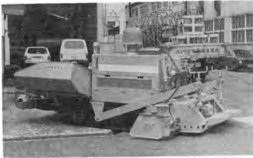
写真-7 範多 AF-250 C 超小型アスファルトフィニッシャ
