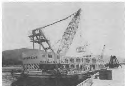
写真-11 神鋼 FD-900 全旋回型クレーン船
