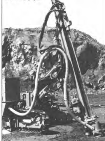
AT-600S型集塵機付 CD-610型 クローラドリル
