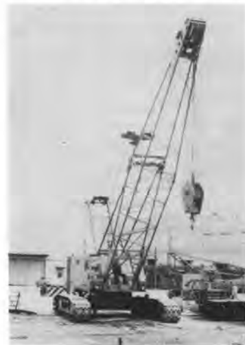
写真-3 神鋼 P & H 5100 クローラクレーン
