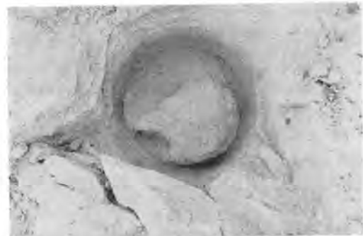
写真-3 鋼管杭(φ400)打設跡(対花崗岩)
