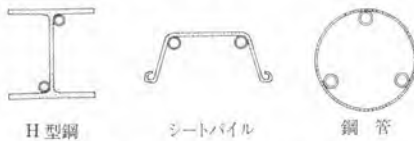
図-3 ジェットパイプの取付配置例
