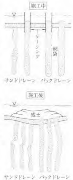
図-5 サンドドレーンとバックドレーンの比較
