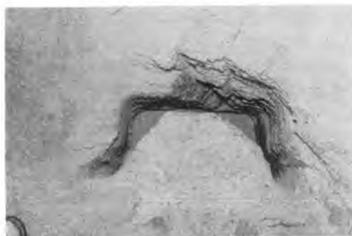
写真-2 IV型鋼矢板打設跡(対花崗岩)
