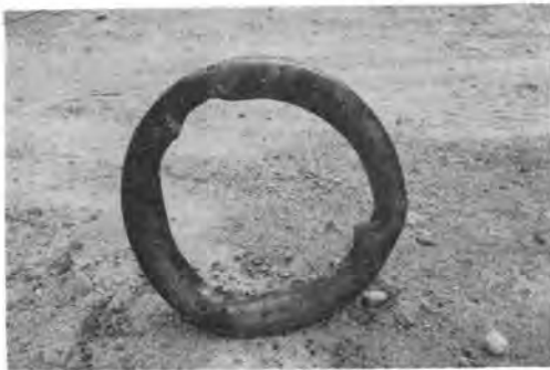
写真-1 杭先端破壊状況
