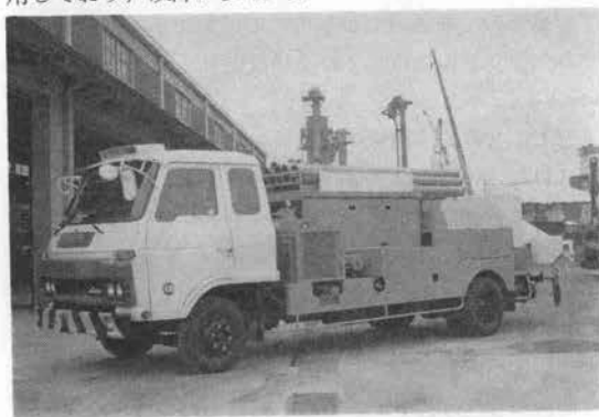
写真-7 ニイガタ・トムセン NCP 910 T コンクリートポンプ
