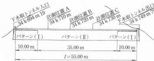
図-1 下木取トンネル概要図
