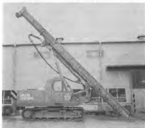
写真-3 日車 DHJ-30 M 20 DS ミニ杭打機
