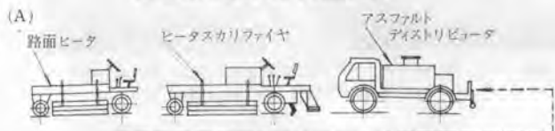
図-3 標準的な加熱—整形—オーバーレイ工法の機械の組合せ (Repave, Standard Procedure)
