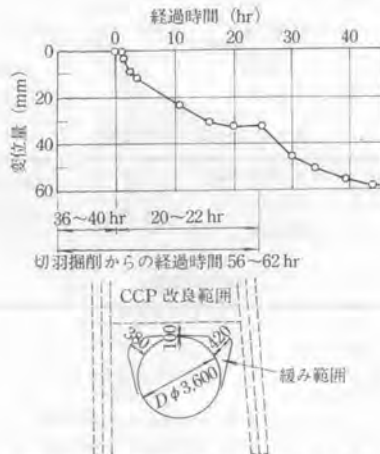
図-6 地山変位測定結果および緩み範囲
