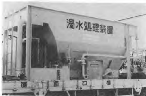
写真-10 日立 P3T 濁水処理装置
