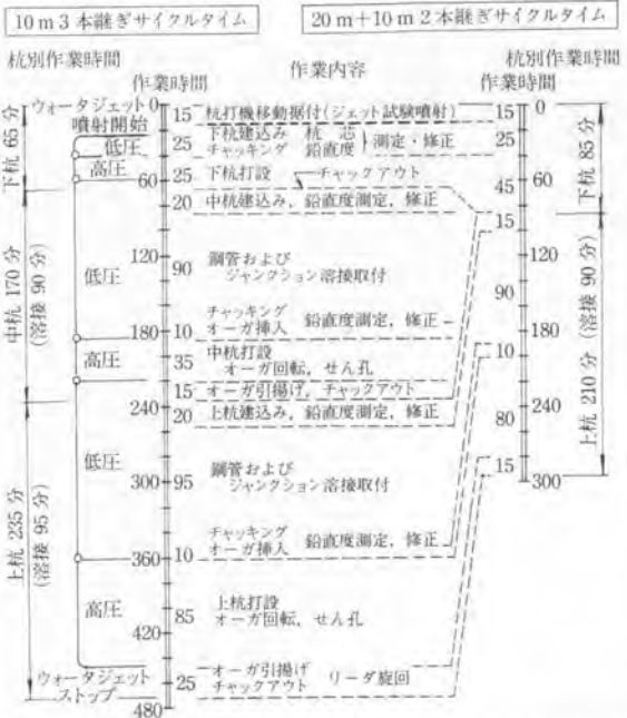
図-6 FHK 杭打機姿図、主な仕様および打設サイクルタイム
