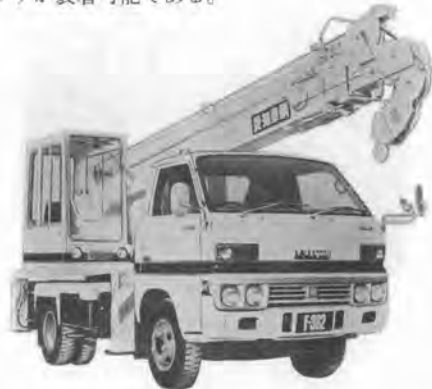
写真-5 愛知 F-302 トラッククレーン
