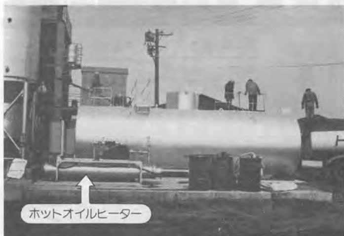
これは60Tonアスファルトプラントにアスファルトタンクヒーターと ホットオイルヒーターを設置した例です。
