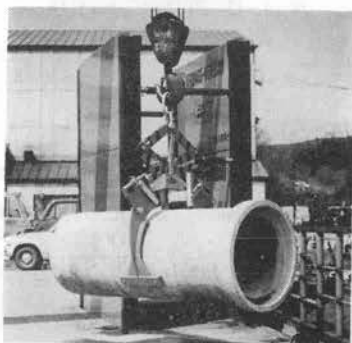
写真-7 新和機械 KKZ オートマチック管つかみ機
