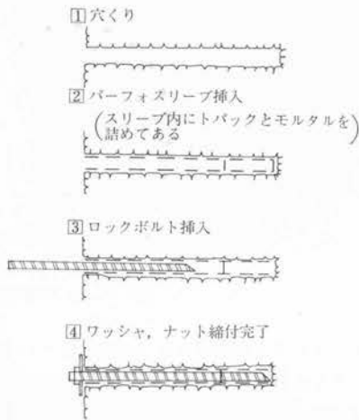
図-8 パフォーアンカー施工図
