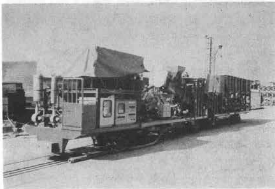
写真-3 レールマウント式 S.E.C 吹付機械装置
