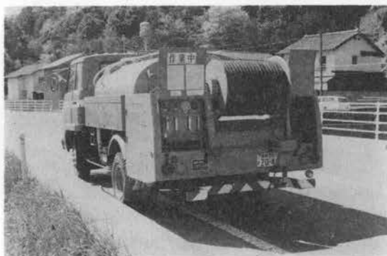
写真-4 4t 級排水管清掃車
