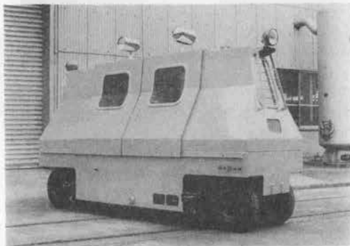
写真-3 バッテリーカー (新幹線保線用トンネル巡回車)
