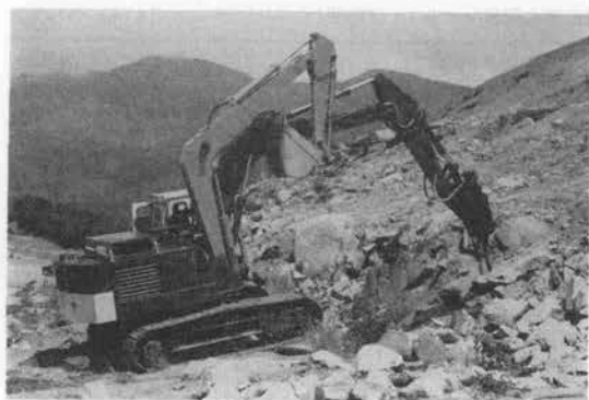
写真-7 ツーブームショベル実験機
