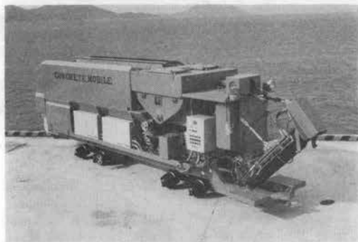
写真-7 スギウ CM-100 T コンクリートモビル
