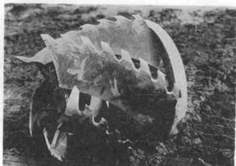
写真-8 浚渫用濁水防止型カッタヘッド
