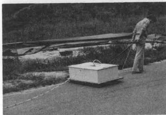
写真-12 地中探査装置 (アンテナを人力でけん引中)
