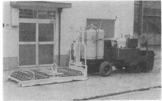
写真-14 範多 HRP-100 路面切削機
