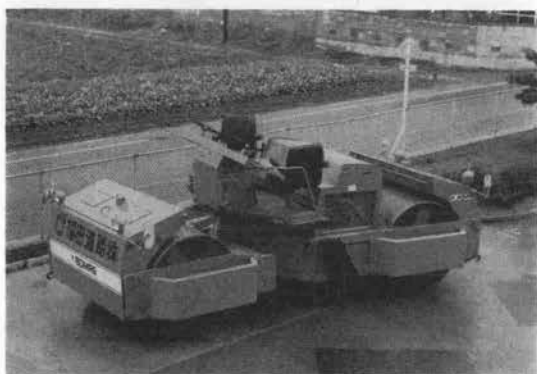
写真-23 大型振動ローラ BW 220 A
