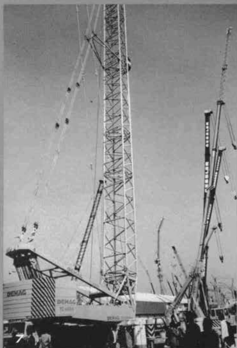
5. いざり式小型ショベル 6. ホイールクレーン 7. 超大型クレーン DEMAG TC 4000 650 t ぶり
