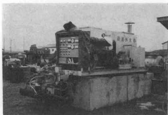
写真—31 エポキシアスファルトデストリビュータ
