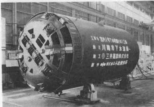
写真-20 ドームヘッド型れき泥水加压シールド
